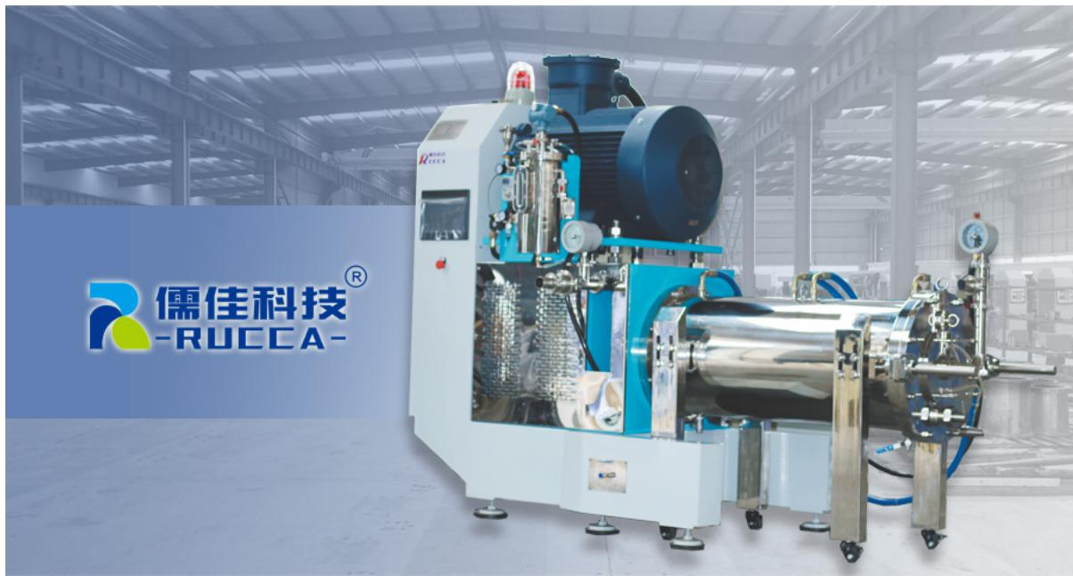
砂磨机是一款湿法分散研磨设备，棒销式砂磨机一般用于水性，溶剂物料的超细分散以及纳米级，应用范围一般在油墨印刷、工业涂料、颜料填料、色浆、药品、化妆品等纳米级的分散研磨。海儒佳机电科技有限公司推出的全新棒销式SF系列砂磨机的特点：
